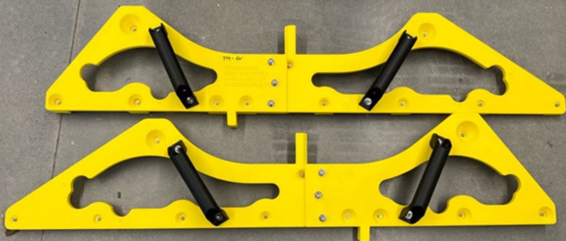
Die Positionierungsvorrichtungen wurden mit gut sichtbarem, gelbem ASA-Material gedruckt. Die Griffe sind standardmäßig ab Lager erhältlich.
