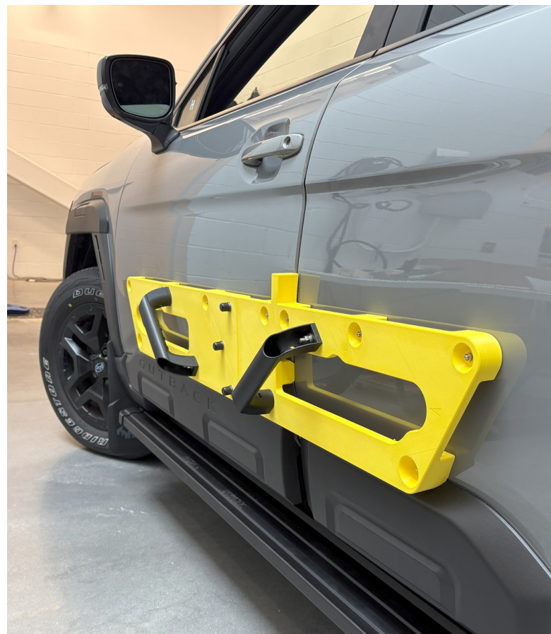
Magnete sorgen dafür, dass die Werkzeuge am Auto haften. Soft-Touch-Pads, die nach dem Druck auf die Werkzeuge geklebt werden, verhindern eine Beschädigung der Oberfläche.
