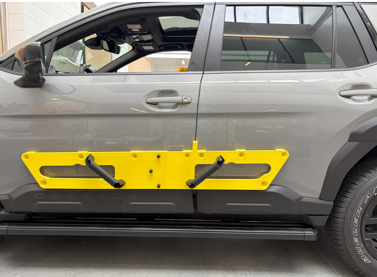
Diese Ansicht zeigt, wie das FDM-Werkzeug verwendet wird, um die Befestigung der Karosserieseitenleisten korrekt zu positionieren.
