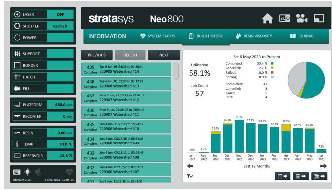
Titanium verfügt über eine Reihe von Reporting Tools und Dashboards, mit denen die Benutzer Daten zu Druckverlauf, Parameterdetails, Hardwarenutzung und Teileverfolgbarkeit erfassen können.
