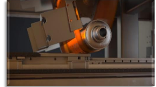
Das Band überträgt die Schicht mit Hitze und Druck auf eine Schiebebühne
